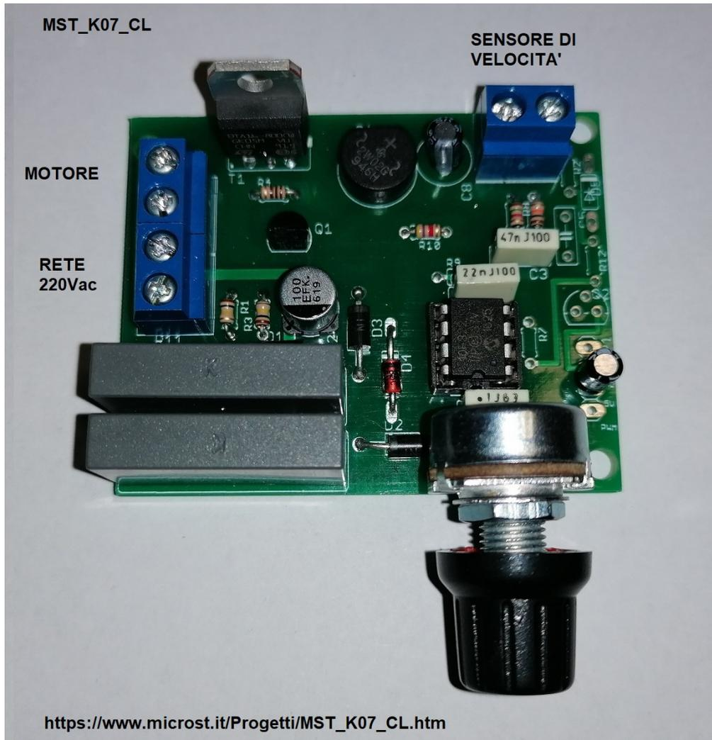
**Fig. 2 - collegamenti elettrici del MST\_K07\_CL nella versione standard**
